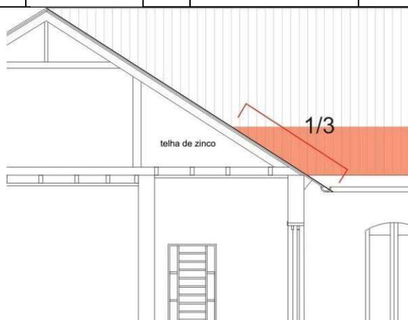
Figura 3 – Área de substituição das telhas da cobertura.
