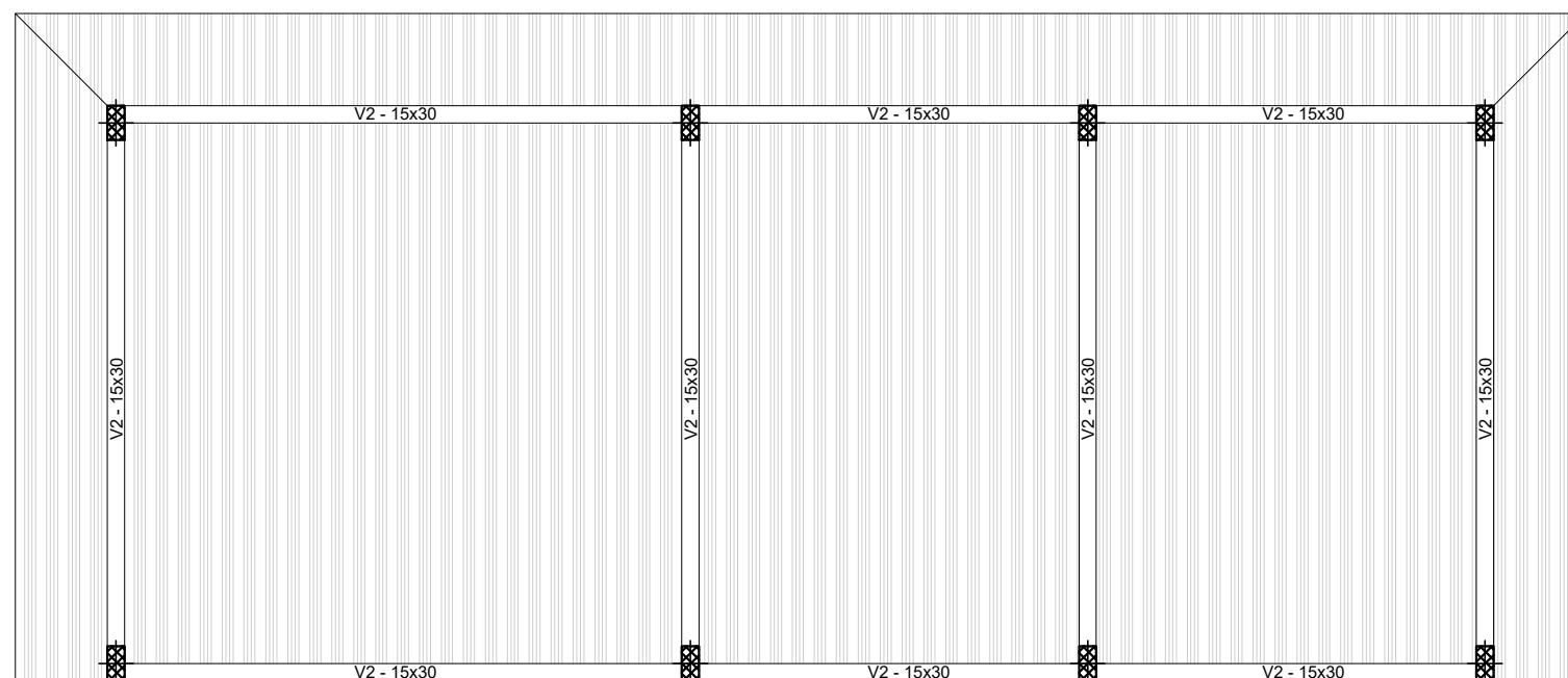
Planta estrutural, pav. cobertura A= 60,19 m 2
