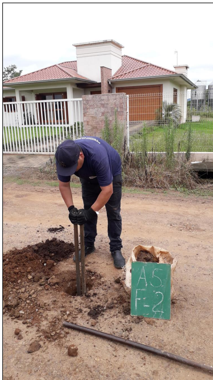
FURO DE SONDAGEM - AS - F2
