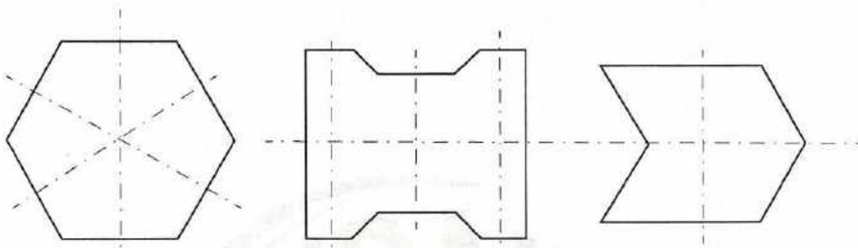
**Figura D.3 — Exemplos de peças de concreto do tipo III**
