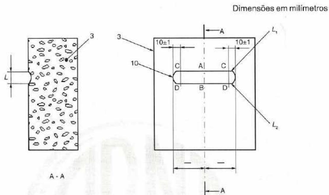
**Figura C.2 — Medição da cavidade na amostra ensaiada**
